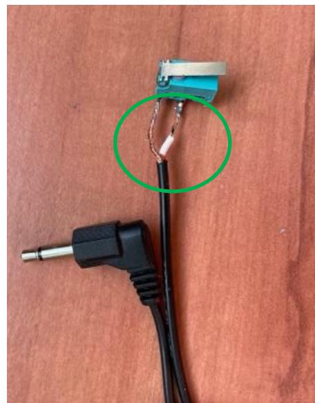
Pour renforcer la liaison des soudures, vous pouvez mettre du thermo rétractable. De plus, un morceau de scotch peut favoriser le maintien du bouton dans le contacteur.
